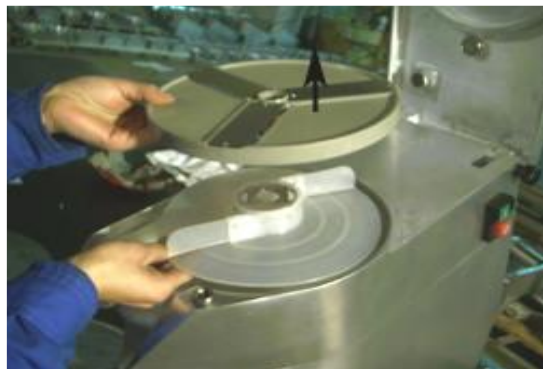
Установка режущей пластины (4)
